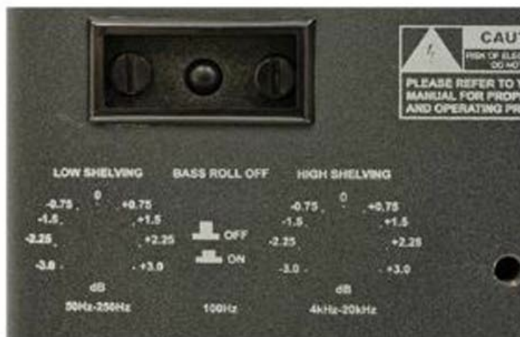
Während die Frequenzweiche des SRP 500 digital realisiert ist, stehen für den Nutzer drei analoge Filter bereit: Ein hohes und ein tiefes Shelving-Filter sowie ein Hochpassfilter.
